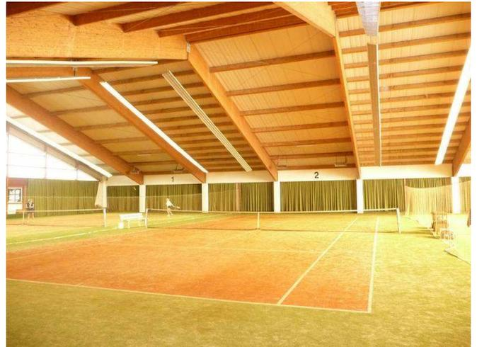
3-Feld-Tennishalle, Spielbelag Kunstrasen mit Quarzsand mit 3 Spielfeldern, Beheizung über Infrarot-Gasstrahler, je Spielfeld Leuchtstoffröhrenbeleuchtung mit Münzautomaten. An der Stirnseite befindet sich der Gastronomiebereich, der über eine verglaste Wand direkten Blick auf die Spielfelder erlaubt. Giebelseiten mit Lüftungsklappen, auf der Gegenseite ein Notausgang.
